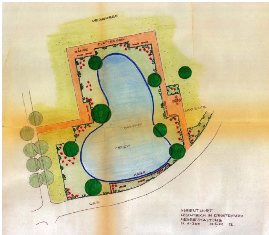
Abb. 14: Neugestaltung des Bereichs um die Teichanlage, 1972-73, mit der erweiterten Wegerschließung, den Sitznischen und der Einfassungsmauer aus Thüster Kalkstein
